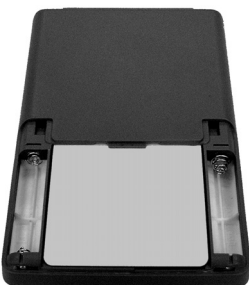
Kontaktiereinheit 2 gesteckte Karte von der Unterseite im Batteriefach
